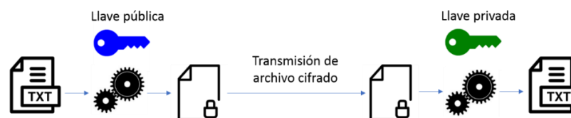
Figura 1. Esquema de transmisión de archivo plano cifrado.
